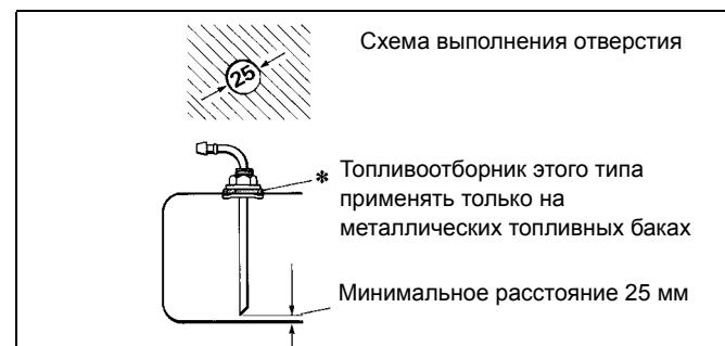
рис. 11: Расположенный на баке отборник топлива Webasto
